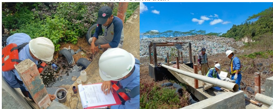
Gambar 3.31 Pengambilan Sampel untuk Pengujian Laboratorium dan Analisa Air Lindi untuk Pengendalian Pencemaran Air dari Operasional TPA Sambutan
